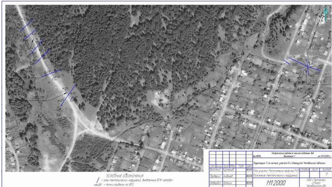
Рисунок 3 Тектонические нарушения, выявленные БГФ методом, и профили РАП на площадях исследований в 7-ом жилом участке г.Златоуста.
